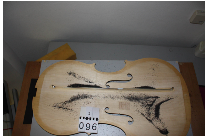
Abbildung 11: Modenlage und -struktur der 2. Mode mit je 12g Masse an den Enden
