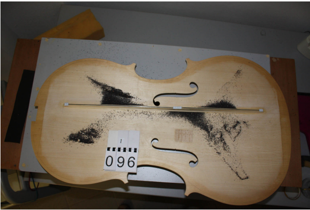
Abbildung 10: Modenlage und -struktur der 2. Mode ohne Zusatzmasse
