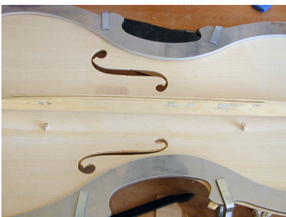
Abbildung 5: Einleimen der unteren Einlage
